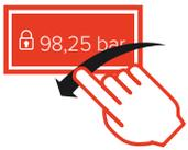
Über den TFT Touch-Screen lassen sich unter anderem 2 PNP Schaltausgänge mittels virtuellem Scroll-Rad schnell und komfortabel einstellen.
